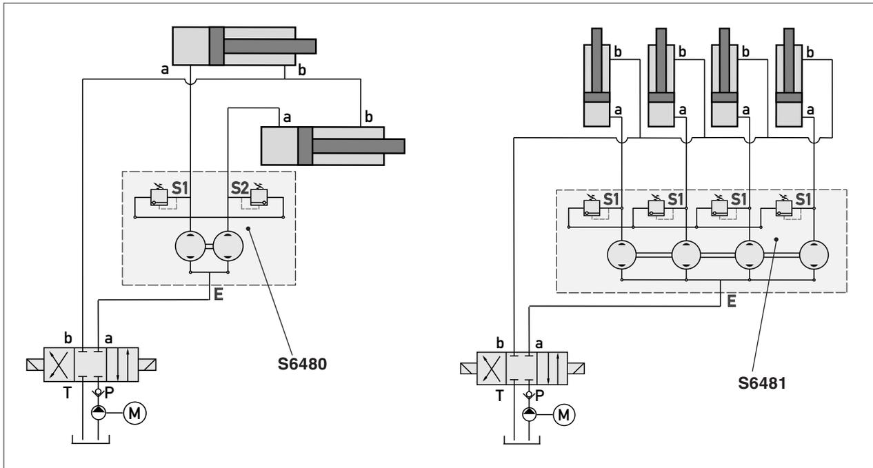
Repartizoarele de flux cu rotatie **S6480** si **S6481** sunt concepute pentru a permite o alimentare sincronizata exacta pentru cilindrii hidraulici cu actionare simpla sau dubla.
