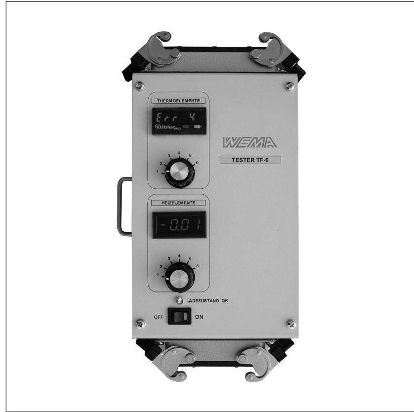
Dispozitivul permite utilizatorului verificarea elementelor de incalzire si a termocuplurilor, inainte de a incepe o noua etapa de productie.
